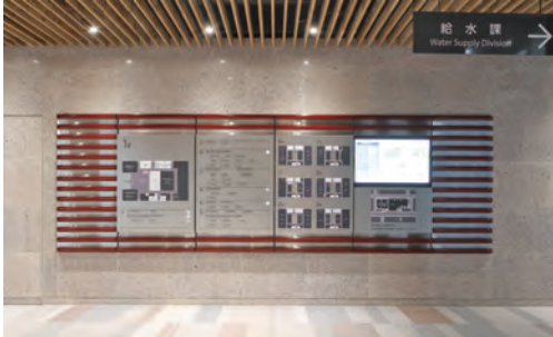
漆塗り総合サイン、県産杉ルーバー天井、庵治石テラゾ壁によるエントランスホール
