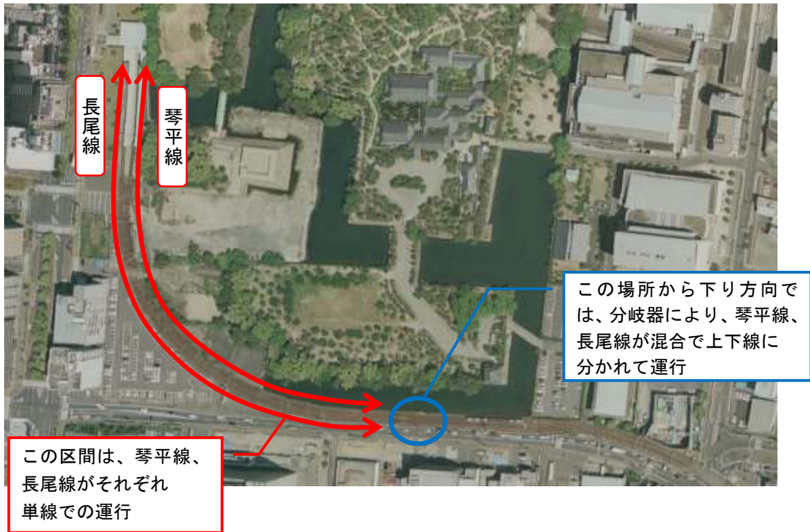
図 3.2 高松築港駅付近の線路配置
