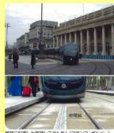
景観に配慮した架線レスのトラム（フランス・ボルドー）
