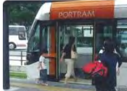
ステップレス化により抵抗感の少なくスムーズな乗り降りを実現(富山ライトレール)
