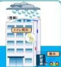
貯留槽に溜めた雨水を トイレ用水・散水等に利用
