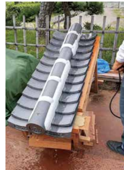
模型を使った雨水排水実験の様子
