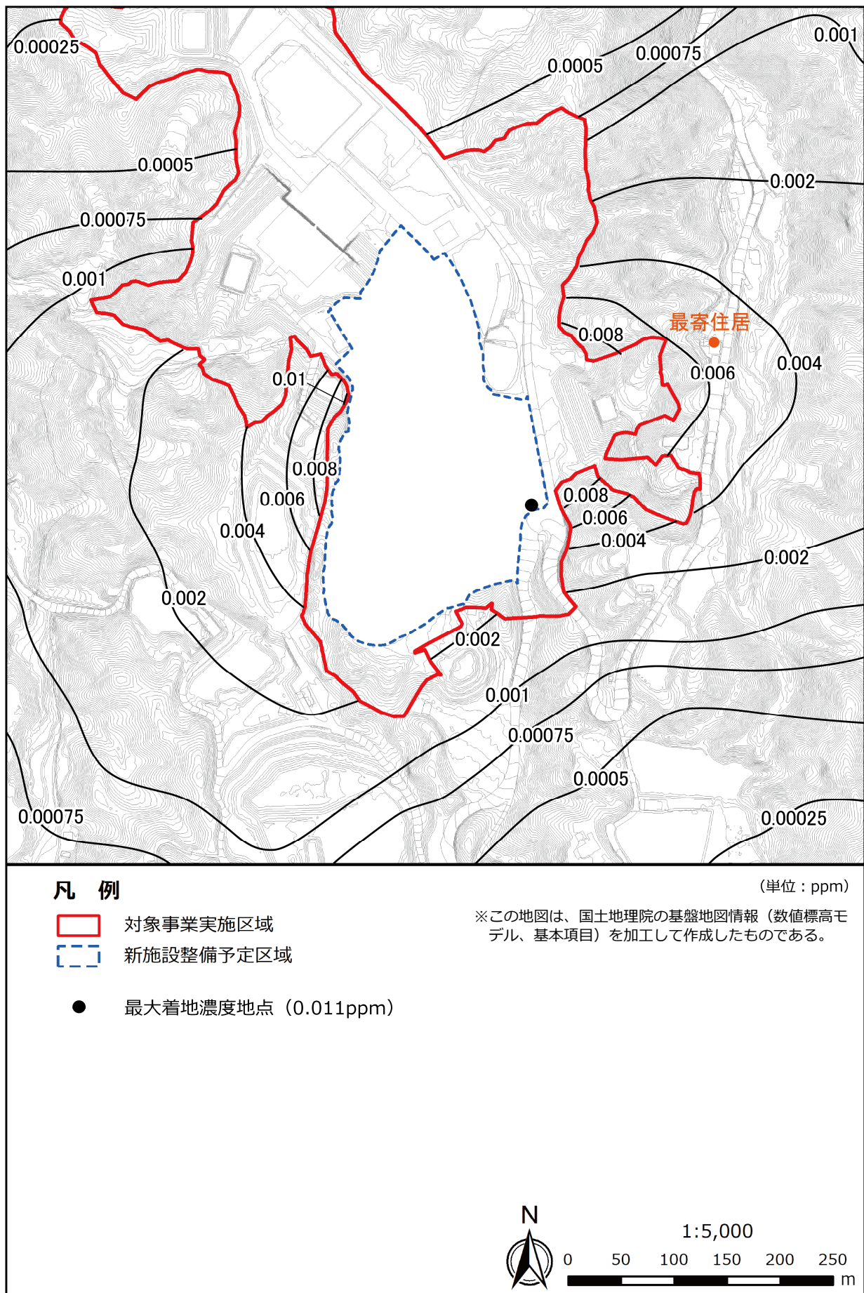
図 6.1.2-13(1) 建設機械の稼働に伴う二酸化窒素の予測結果 (寄与分)
