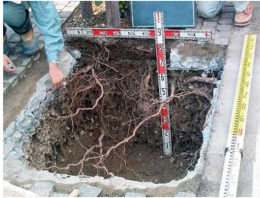
図 4-1-10 基盤内への根系伸長の様子
