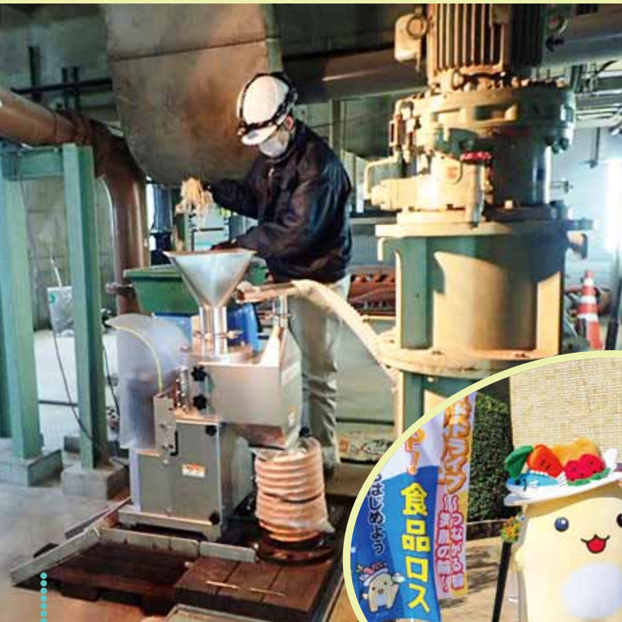
食品廃棄物(廃棄うどん)投入による バイオマス発電の効率化に向けた実験
