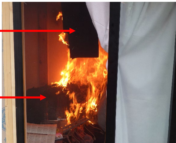
他の洗濯物に燃え移っている状況
