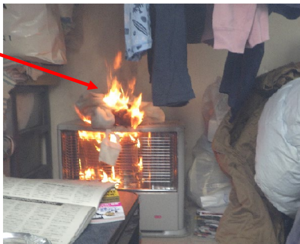
ストーブの上で干していた洗濯物が落下した状況
