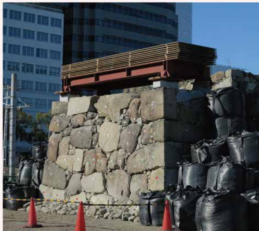
石垣の仮積みと載荷試験
