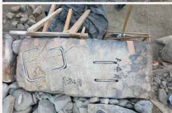
石垣の仮積みと載荷試験
