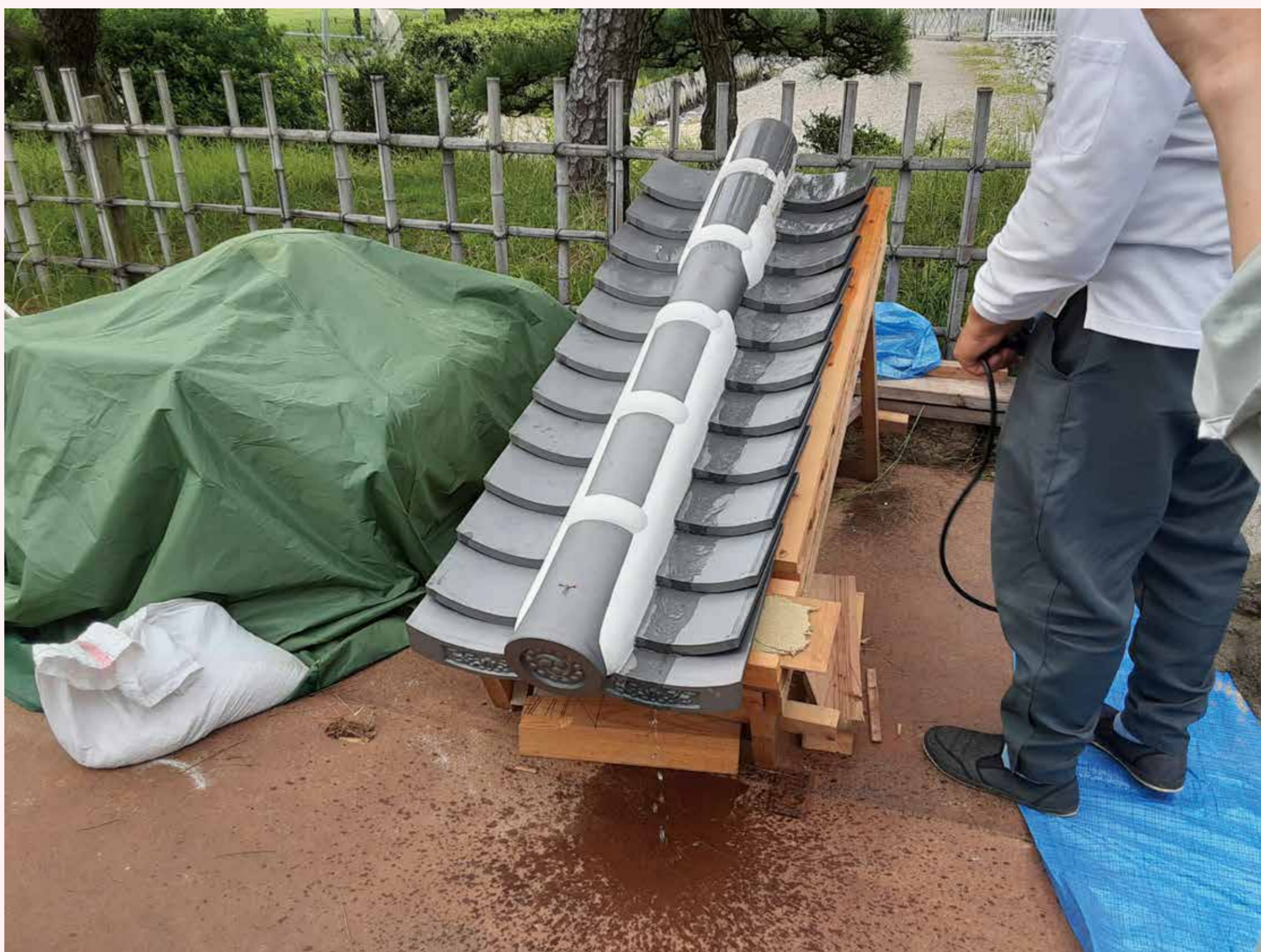
模型を使った雨水排水実験
