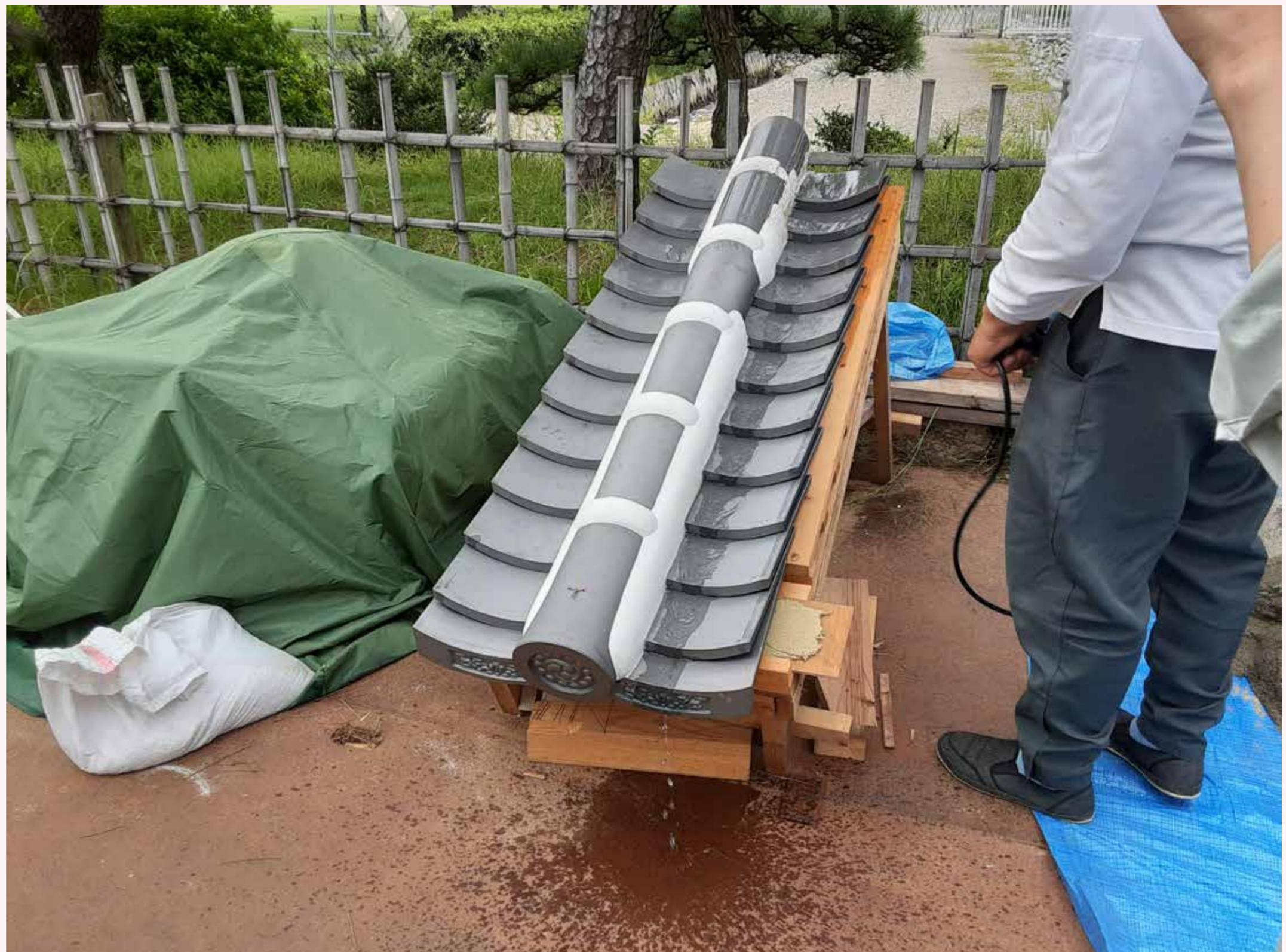
模型を使った雨水排水実験
