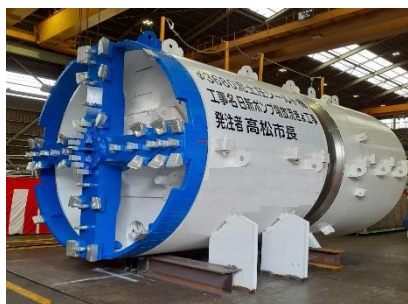
シールドマシン(工場検査時)
