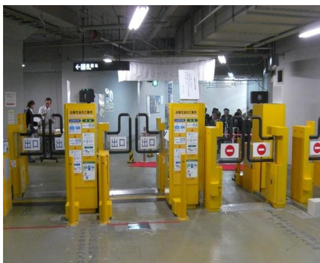
自転車1台ずつにICタグを取り付け、すべてのサイクルポートで利用カード（磁気カードやICカード）を機械が読み込める、一元化された管理システムを採用することで、24時間以内ならどのポートで何回出し入れしても追加料金はかかりず、スムーズに入出庫が出来るようになりました。
