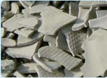
浄水汚泥（脱水処理後）
