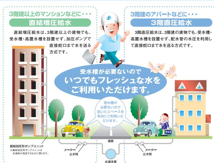
3階直圧給水方式と直結増圧給水方式の仕組み
