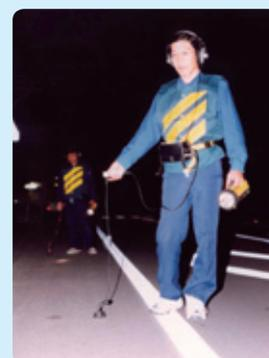
路面音聴による漏水調査
