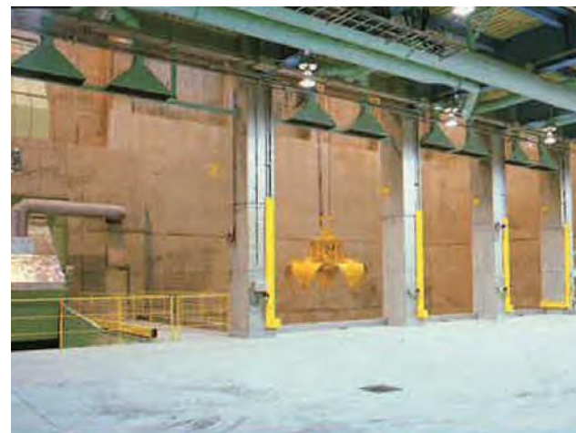
収集した破碎ごみ粗大ごみはごみピットへ投入します。
