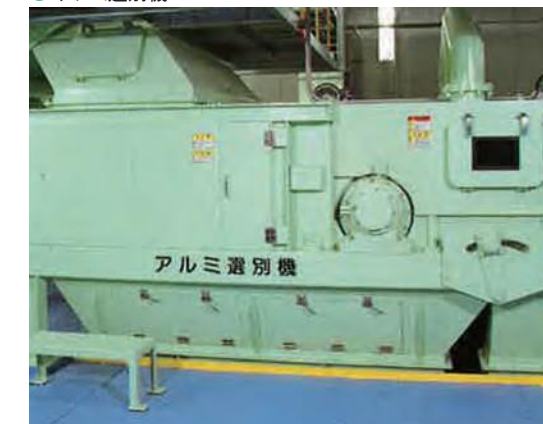
粒度選別機で選別されたごみからアルミを回収します。
