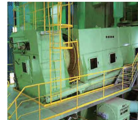
回転するドラム内で不燃物アルミ、可燃物とプラスチックの混合物に分離します。
