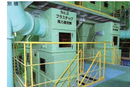
風力で可燃物及びプラスチックを選別します。
