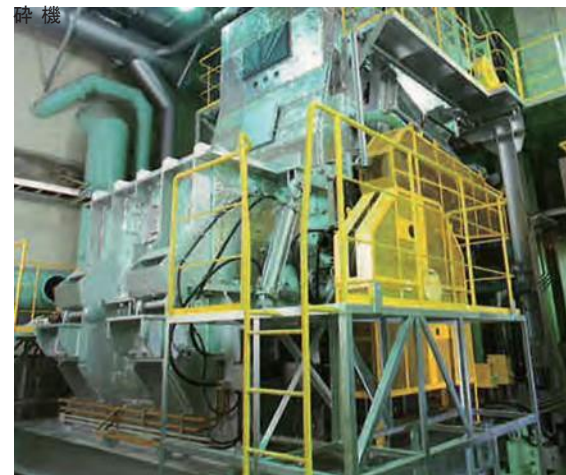
破碎ごみは回転式破碎機で破碎します。
