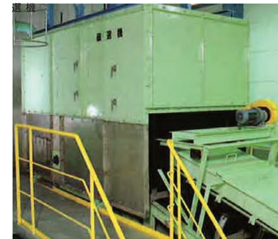
磁選機で鉄分を回収します。
