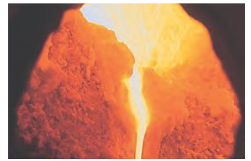
溶融炉内から高温の slags が冷却装置に流れていきます。
