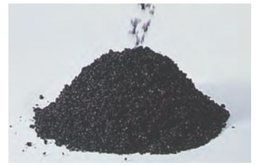
溶融固化物冷却装置内の水で冷却された液体状のスラグは、はじけて小さな粒状となり固化します。それを、溶融固化物と呼びます。
