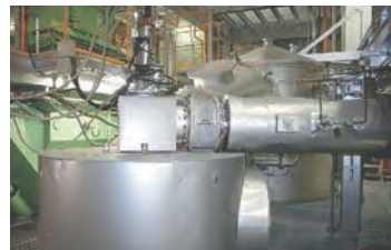
供給されたごみはガス化炉で流動化した砂と混合し、ガス化熱分解し、溶融炉で高温空気により燃焼・溶融してスラグ化します。
