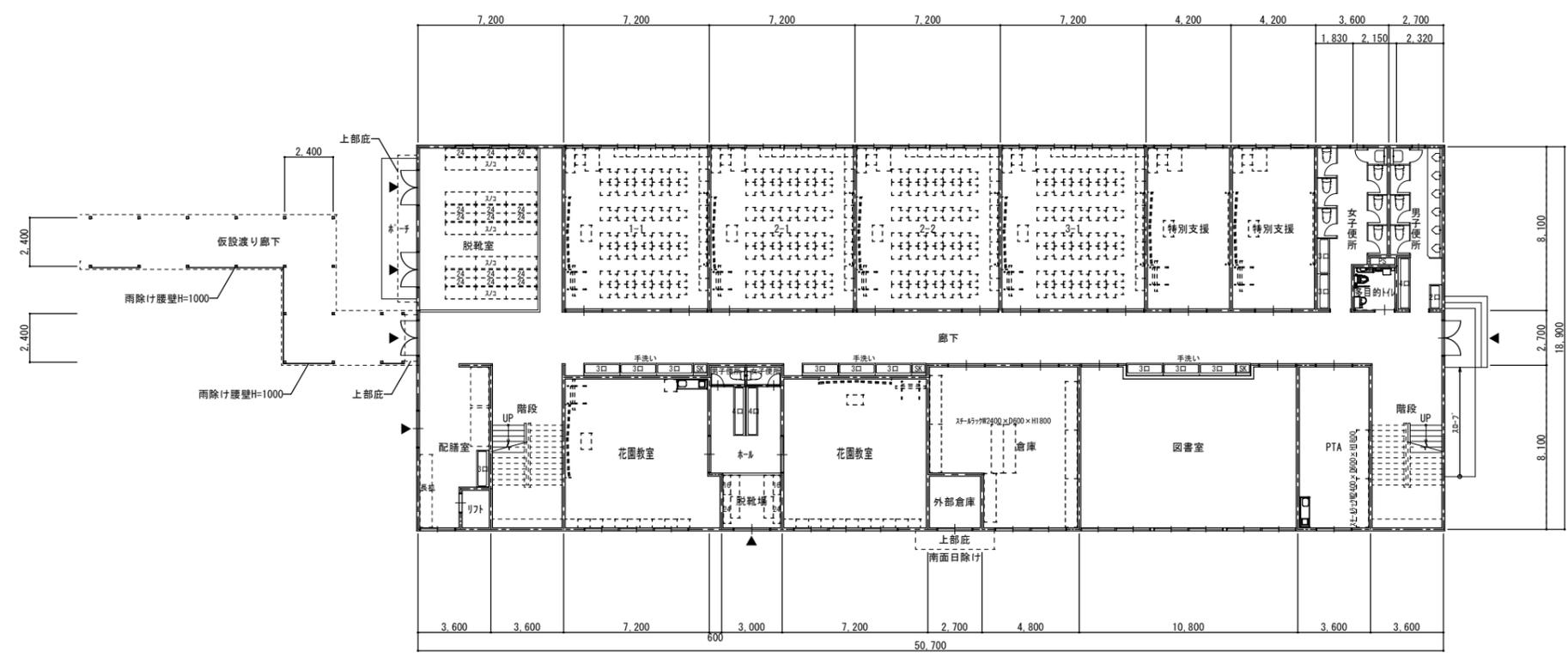
1階平面図 S=1/100 床面積:958.23㎡
