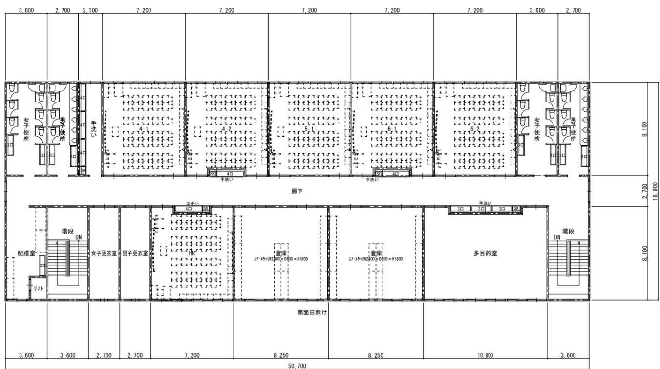
2階平面図 S=1/100 床面積:958.23㎡
