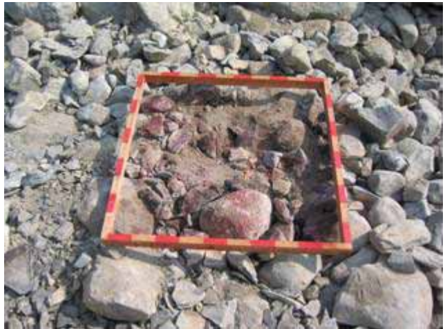
写真6 栗石サンプル調査状況 1 m 2 中の栗石の粒径・形状を調査
