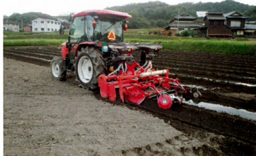
直進アシスト機能付きトラクターによる同時施肥、耕起、畝立て成型、マルチングの様子
