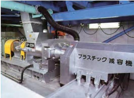
選別されたプラスチックを減容固化します。
