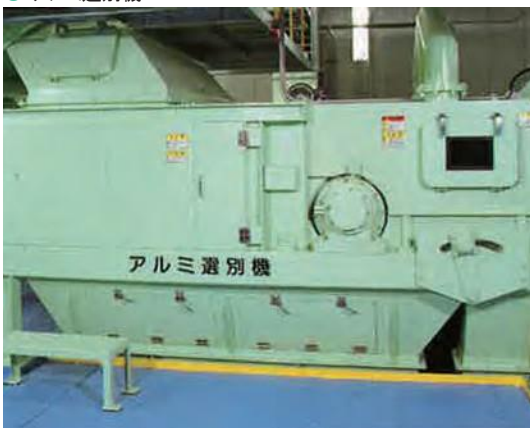
粒度選別機で選別されたごみからアルミを回収します。
