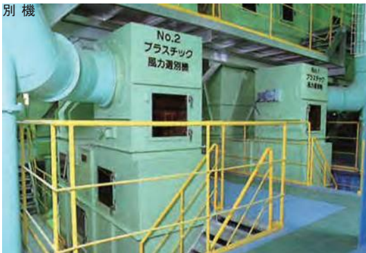
風力で可燃物及びプラスチックを選別します。
