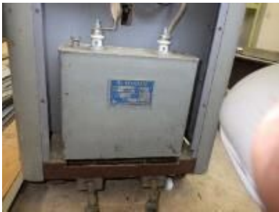
電気溶接機の側面に取り付けられた低圧コンデンサー
