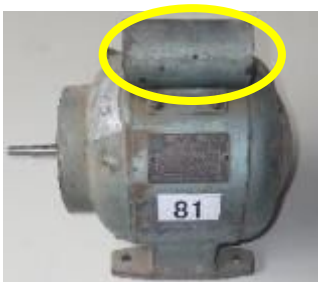
単相モーターに取り付けられた低圧コンデンサー
