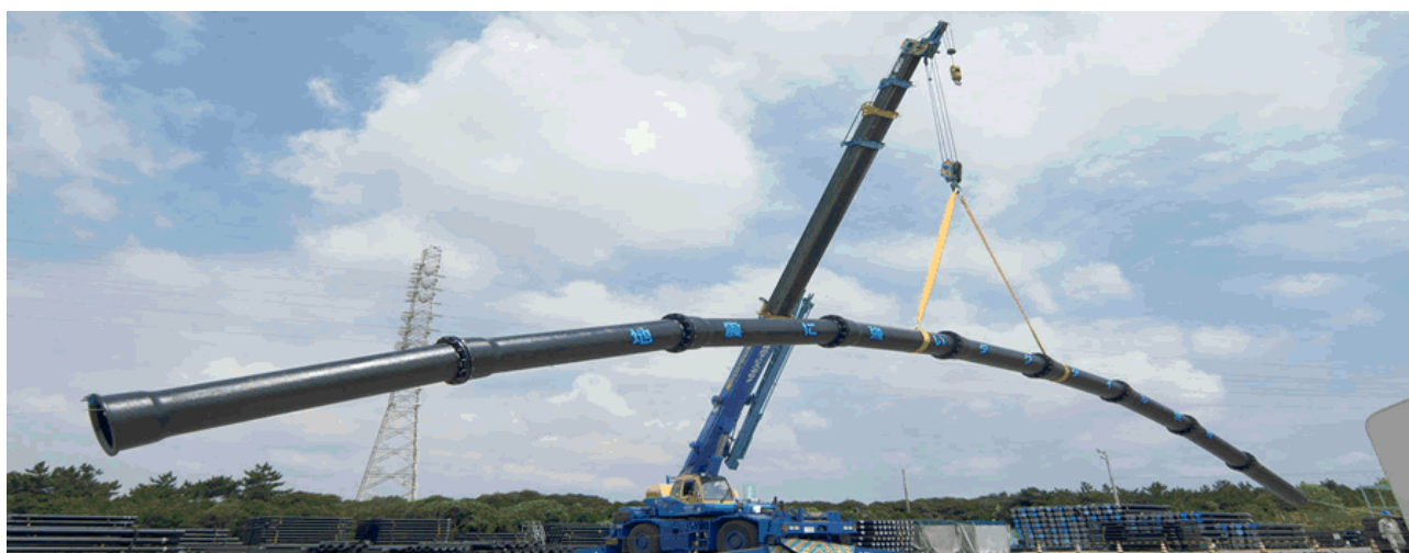
耐震管の地震時の地盤変位対応性のデモンストレーション
