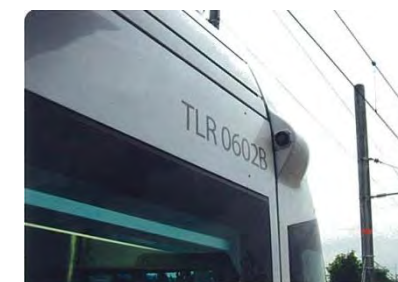
車内カメラ 側方カメラ 各種カメラによる安全性の向上（富山ライトレール）
