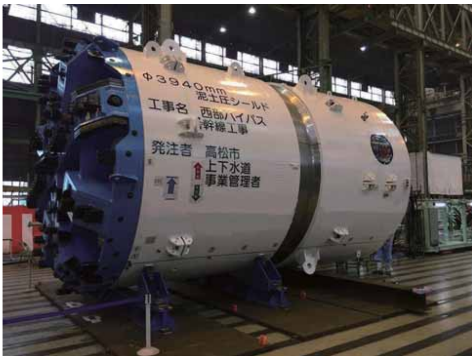
西部バイパス幹線シールドマシン
