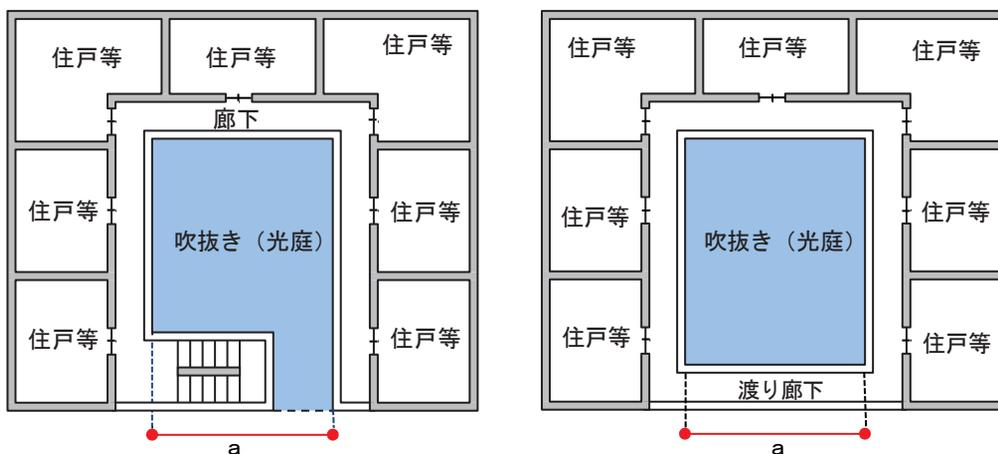
$$a \geq \text{光庭の周長のおおむね} 1/8 \text{ かつ } a \geq 2 \text{ m}$$
