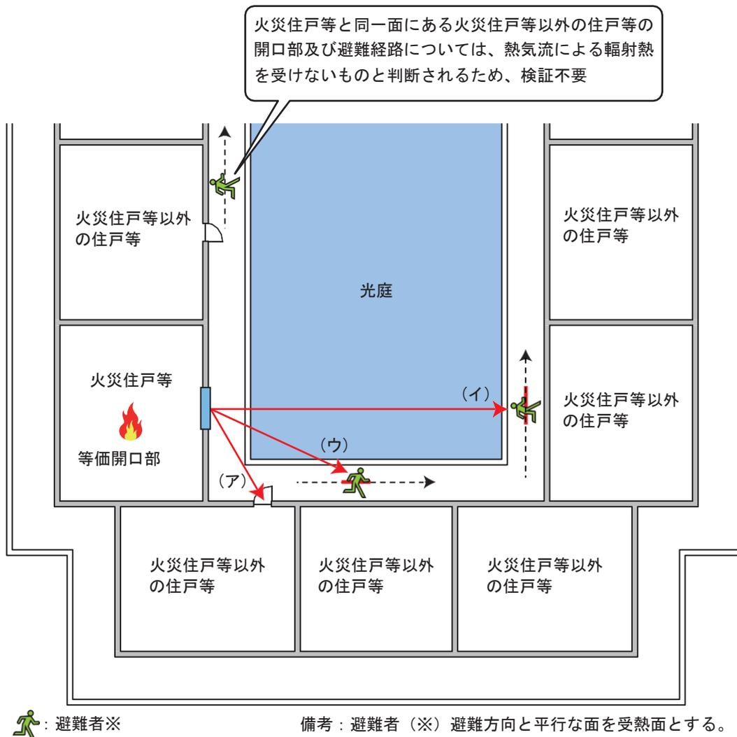
イ 位置・構造告示第4第1号(2)ロ(イ)に規定する「避難光庭の高さ」及び「避難光庭の幅」の計測方法は、次によること。
