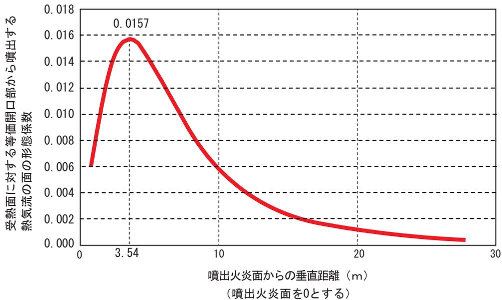
計算プログラムにより、噴出火炎面からの垂直距離が3.54mの位置が受熱量が大きくなると想定される部分となる。
