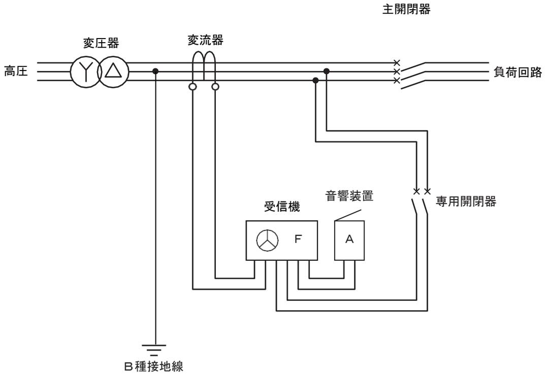
(その4) 変圧器の二次側低圧電路に接続されたB種接地線に変流器を設ける方式の場合の例
