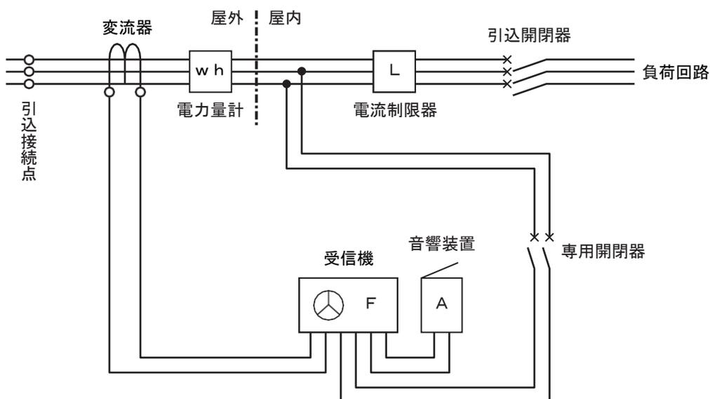
(その3) 変圧器の二次側低圧電路に変流器を設ける方式の場合の例
