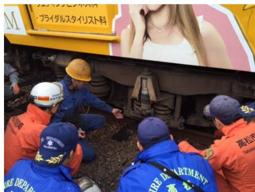
2. 重量物を排除する資機材を、電車に設定して昇降状況を確認しています。周囲の状況を確認しながら、負傷者を助けるうえで、二次災害防止（隊員が受傷しないこと）に留意して訓練に臨んでいます。
