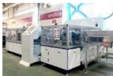
太陽光パネルリサイクル設備
